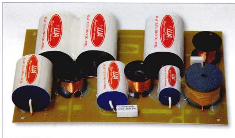
Die Frequenzweiche der Lua „Con Espressione“ sitzt über der Bodenplatte und ist mit den Magic-Sound-Capacitors für den ausgezeichneten Klang verantwortlich
