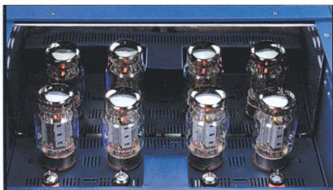
Die neuen, hauseigenen Lua-Endröhren vom Typ KT88 sind penibel selektiert und gematcht, sprich aufeinander abgestimmt
